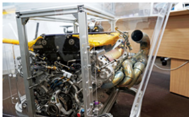
トヨタのF1車体に搭載されていたエンジンの実物。前任の教員から譲り受けたあと、特注のアクリルケースに入れて打ち合わせテーブルとして使用。「ものすごい技術と素材が結集しています。見どころは語りきれません(笑)」
